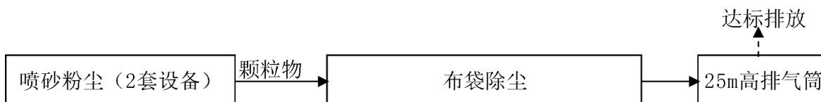
图 7.1-1 项目喷砂布袋除尘净化工艺流程图
